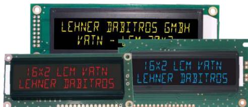
VATN / EBTN stehen als Alternative zu herkömmlichen monochromen LCD-Segment und OLED-Anzeigen zur Verfügung. Diese Technologie in negativ Mode zeichnet sich mit einem besseren Ablesewinkel, einem hohen Kontrast und unterschiedlichen Farbgebungen der Zeichen aus. Alle bekannten Zeichensätze stehen für Charakter Module zur Verfügung.
